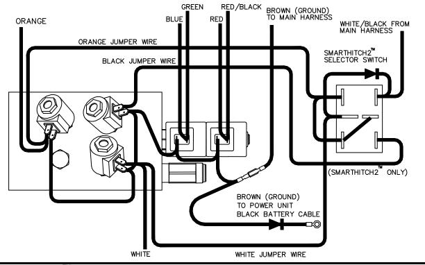
Figure 13. SmartHitch2<sup>™</sup> Wiring Diagram
